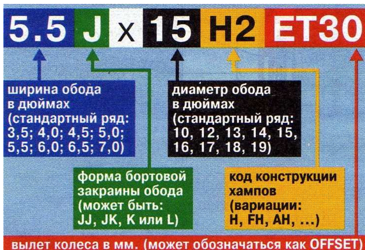
Рисунок 2.20 – Характеристика дискового колеса легкового автомобиля
