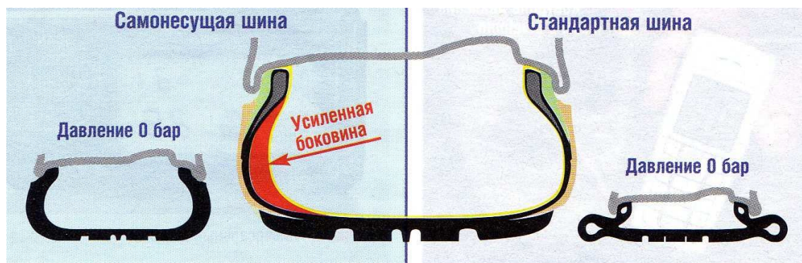
Рисунок 1.22 – Самонесущая и обычная шины при номинальном и нулевом давлении воздуха
